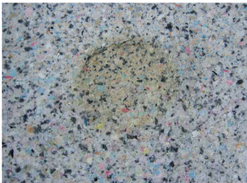
Bild 4: Schaumstoff nach Dauertrittbelastung
