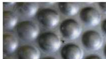
Bild 6: Schalenmatte Unterseite nach Dauertrittbelastung
